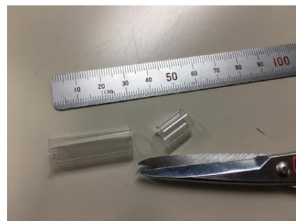
2. 塩化ビニールチューブ (内径 7mm 外径 9mm) は 10mm くらいの長さのリング状に切る。
