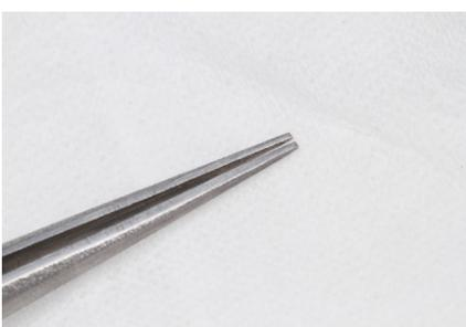
9. 側面と外側を直線的に研いだピンセットは、先は裁断状になっていて「角が立っている状態になる。このままだと掴む対象物に傷をつけてしまいやすいので、これから角を丸くするような研ぎ方をしていく。
