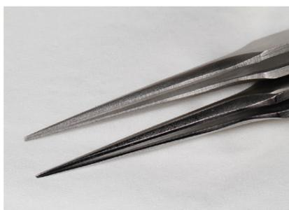
18. KFI K-3GG のピンセットの新品 (左上) と、ピカール仕上げを施し研磨調整の完了したもの (右下)
