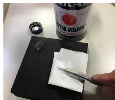
16. ピカール (金属磨き用の液状コンパウンド) を折ったティッシュ or キムワイブに少量つけ、ピンセットを磨く。耐水ペーパー #2000 で表面全体をきれいにしておくと、この作業でピンセットの表面がとても綺麗になる。表面積が小さくなるので、腐食しにくくなるが、ギラつきが気になる人はやりすぎに注意する。
