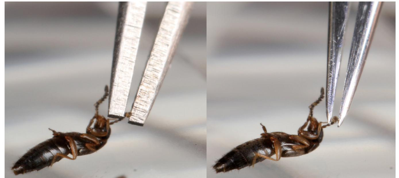
研磨によって調整したピンセットの先端；左：未調整、右：調整済み
