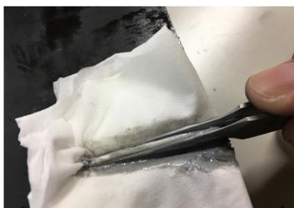
17. ピカールを浸ませたティッシュ or キムワイブをピンセットで挟むようにして磨き、内面とその角を磨く。ピンセットの内面を研ぐのは難しいが、この程度であればかみ合わせ精度が狂うことはない。
