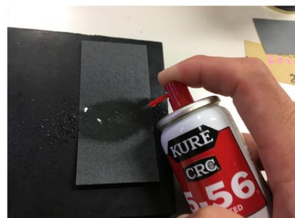
4. 耐水ペーパー #400 (3cm×8cm にあらかじめ切っておくとよい) を作業台のゴム板 (10cm×10cm×2cm) にのせ、CRC 5-56 (潤滑油) を軽く吹きかける。潤滑油を用いると、水研ぎにくらべなめらかな研ぎ味になることと、耐水ペーパーの端が丸まるなどせず使える。しかし、油脂の使用が禁忌される作業用のピンセットなどであれば水研ぎとする。
