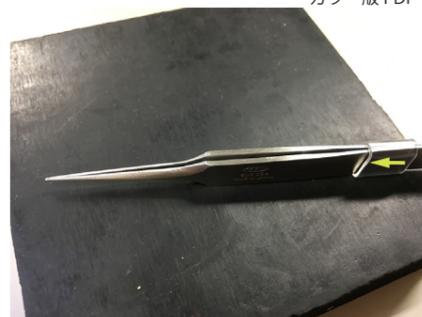
3. 切った塩化ビニールチューブをピンセットのおしりのところにはめる。このリングをゆっくりと前にスライドさせるとピンセットの先端が閉じていくので、ぴったりと閉じたところで止める。ピンセットを研ぐのは基本的にこの状態で行う。リングの代わりにビニールテープなどを用いてもよい
