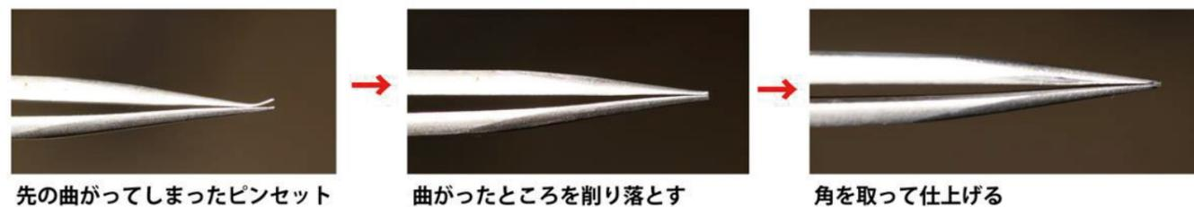
先端の曲がってしまったピンセットの修正
